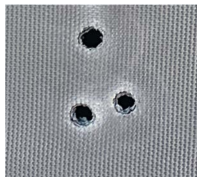
Figur 9 9,3 mm ekspanderende jaktammunisjon skutt på 3,2 mm gummiduk
