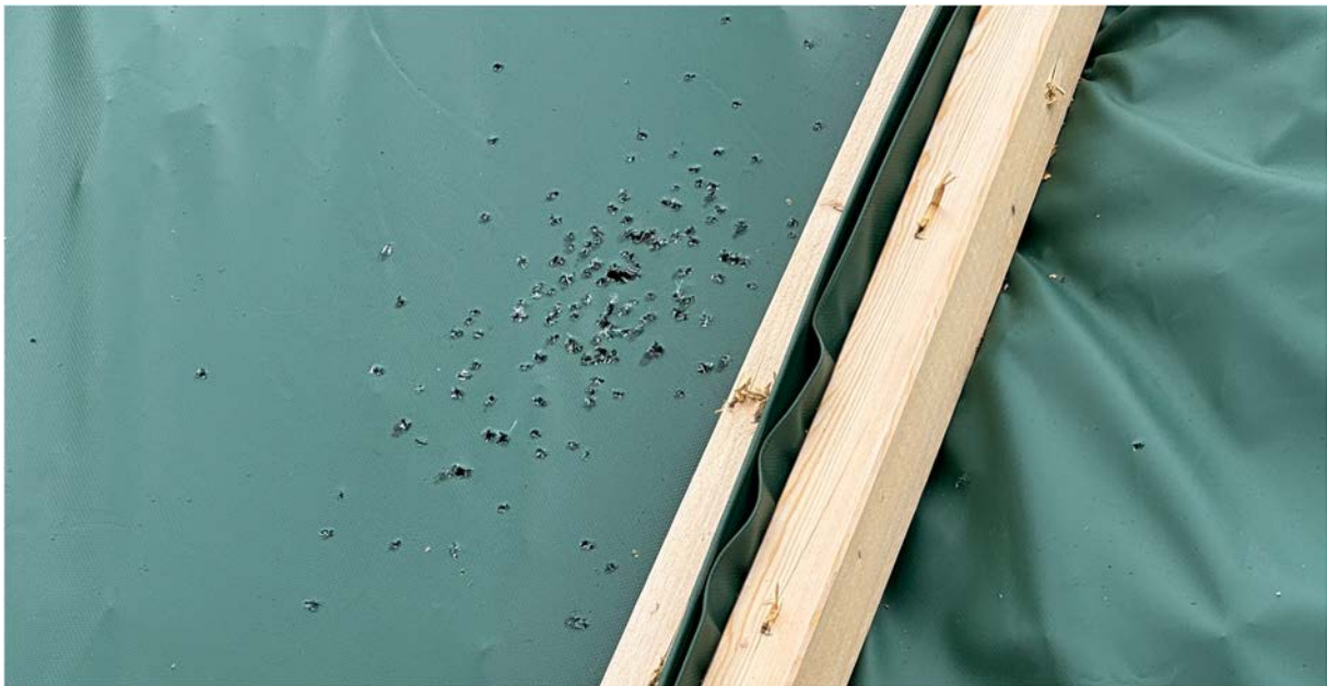
Figur 17 Hull i presenningen etter noe tids skyting like ved skjøten mellom to presenninger
