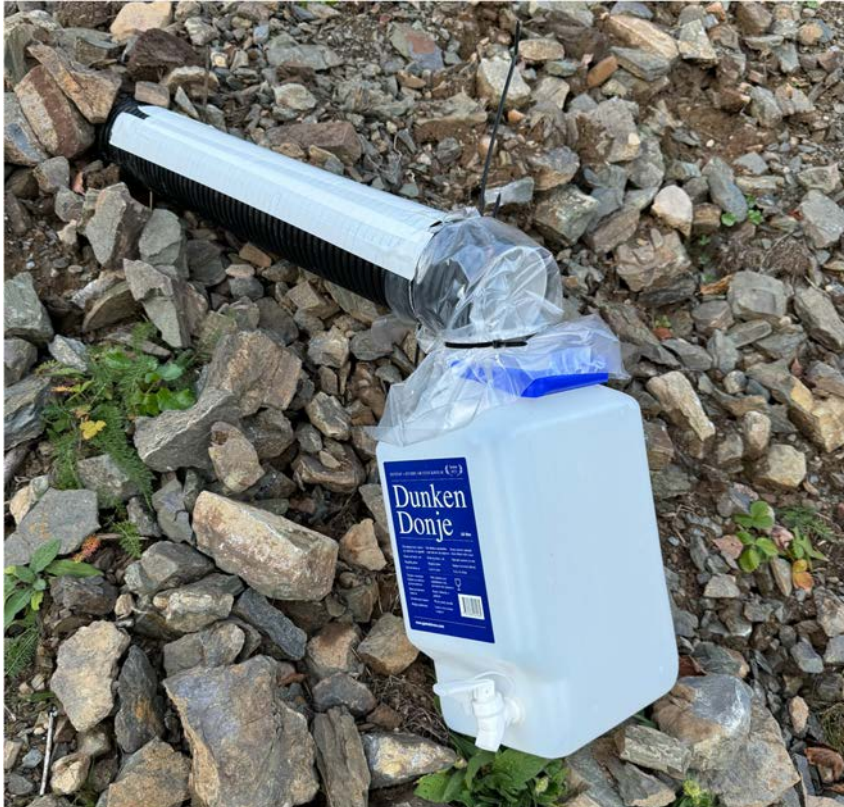
Figur 11 Enden av drensrør 2 ført inn i plastdunk
