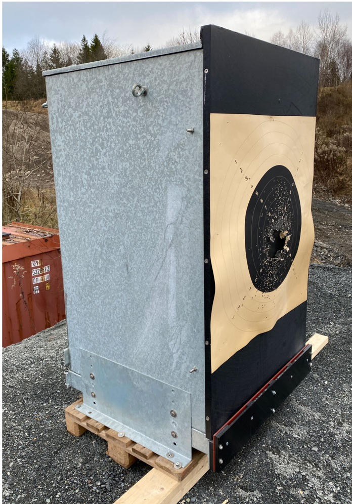
Figur 10 Kulefangerkassett fra Leu & Helfenstein AG. Pappskiven er brukt til å sikte på under testskytingen
