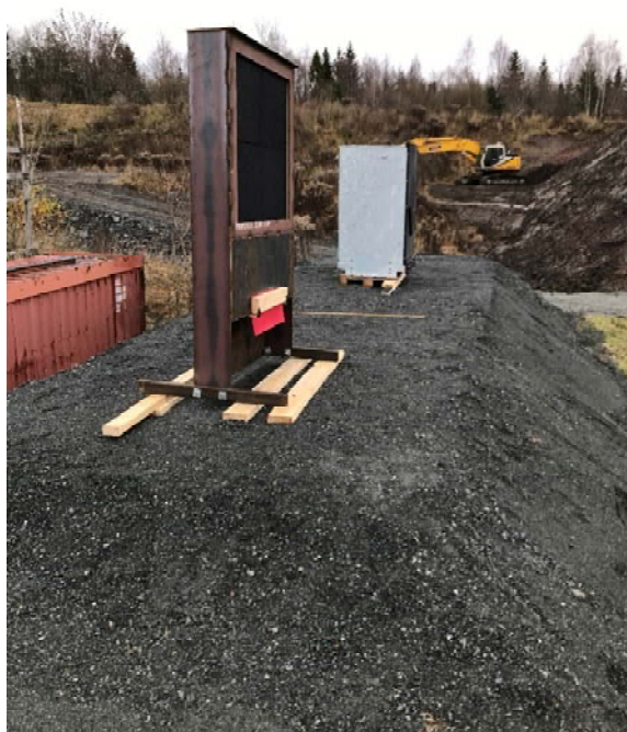
Figur 2 De to stålkulefangene fra siden. Tommestokken viser avgrensingen mellom de to flatene (med hvert sitt kulefang) det ble tatt prøver av (COWI).
