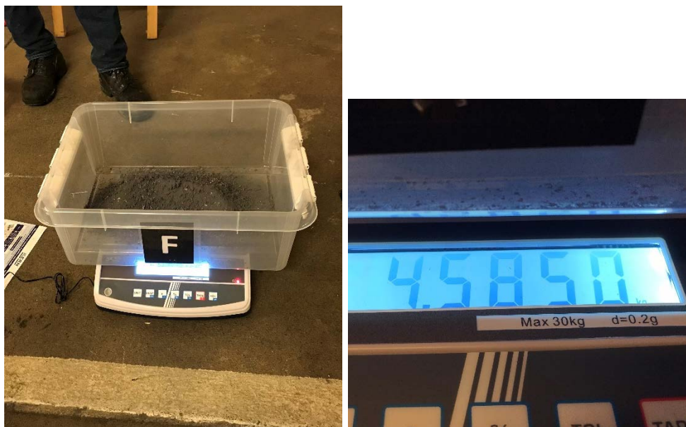
Figur 8 Oppsamlingskasse fra stål 1 fylles over i plastboks F venstre bilde. Høyre bilde viser restene av prosjektilene i plastboksen (COWI).
