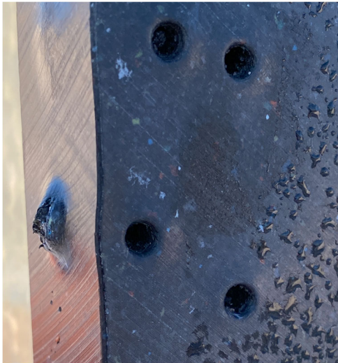
Figur 31 Kaliber .22 LR skutt på kanten av HDPE- plate
