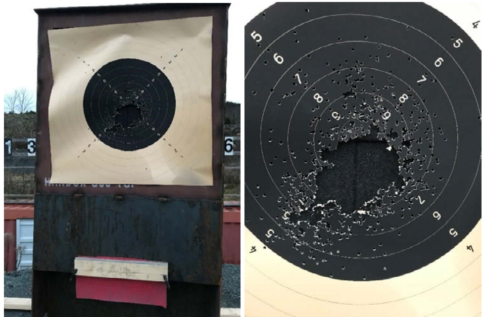
Figur 14 Resultatet for stål 1 etter runde 2. Ikke synlige hull i regupol platene (COWI).
