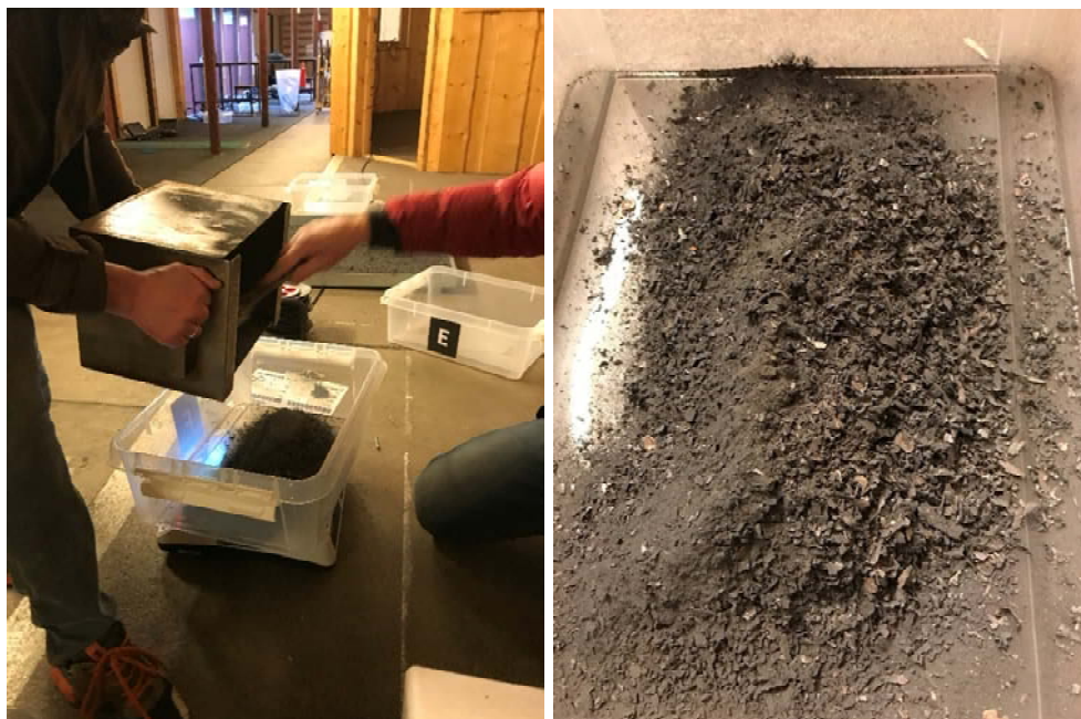
Figur 8 Oppsamlingskasse fra stål 1 fylles over i plastboks F venstre bilde. Høyre bilde viser restene av prosjektilene i plastboksen (COWI).
