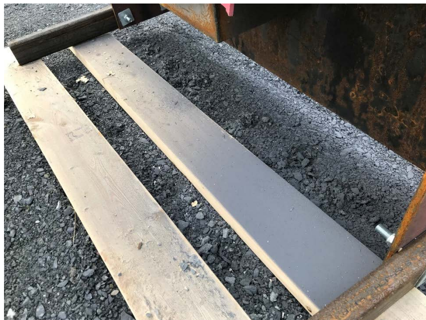
Figur 7 Synlig grått metallstøv under stålkulefang 1 (COWI).
