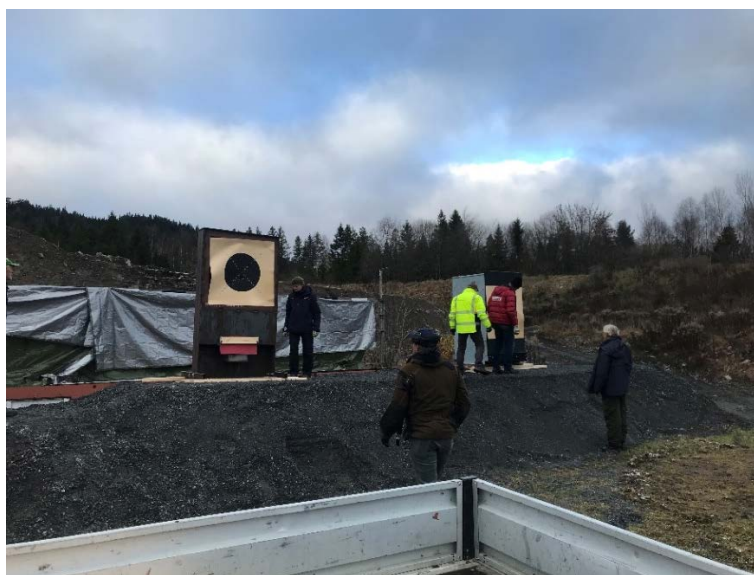
Figur 5 Bilde etter runde 1. Blinkene ble plassert på en voll i forkant av skivene. I bakgrunn kan en se presenningen som skulle fange opp eventuelle bomskudd. I framkant vises bilhengeren som skuffen fra stål 2 ble transport bort med (COWI).
