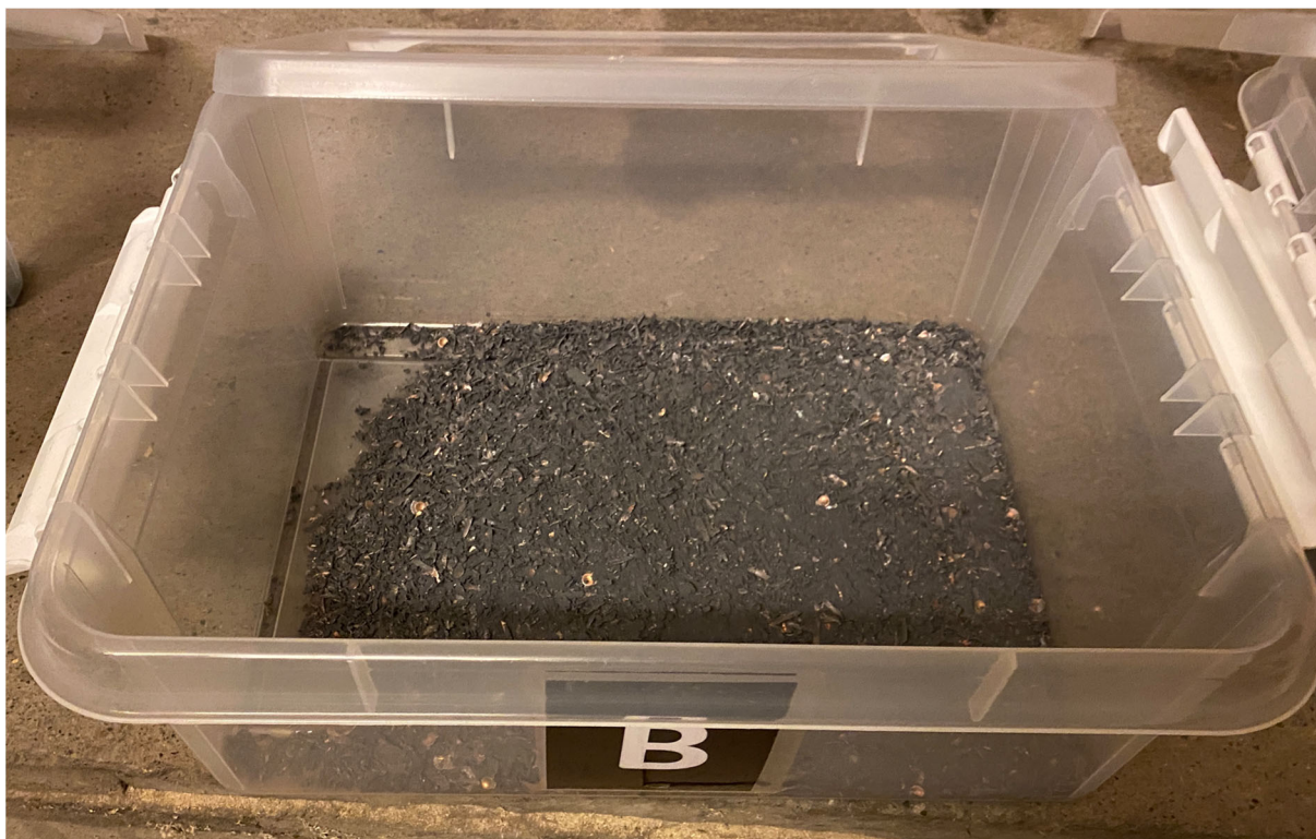
Figur 16 Kule-rester fra prototypekulefanget
