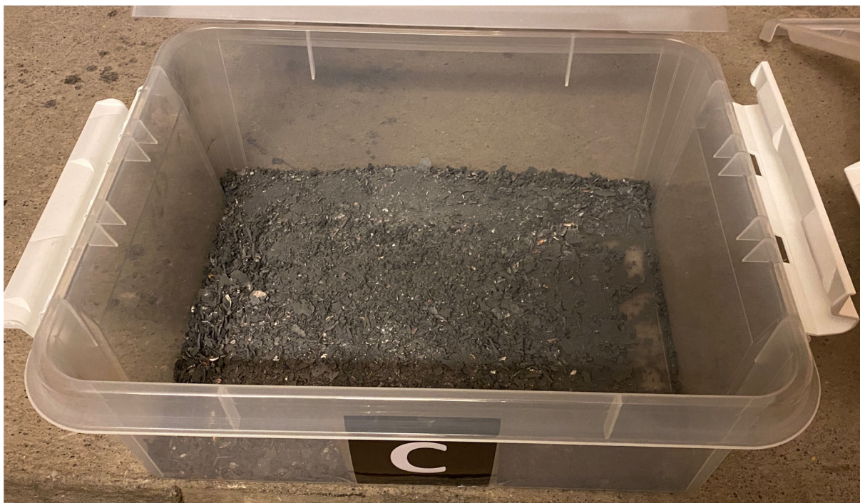
Figur 15 Kule-rester fra kulefangerkassetten fra Leu + Helfenstein AG
