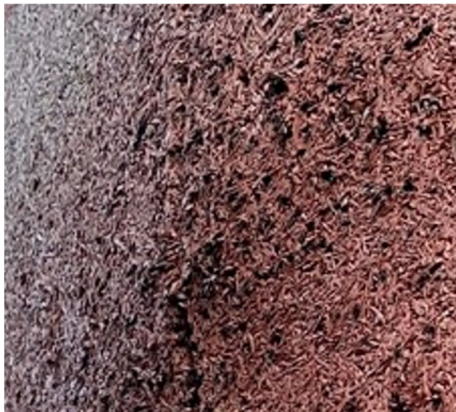
Figur 17 Regupolplater etter skyting med jaktammunisjon (Indre Breim)
