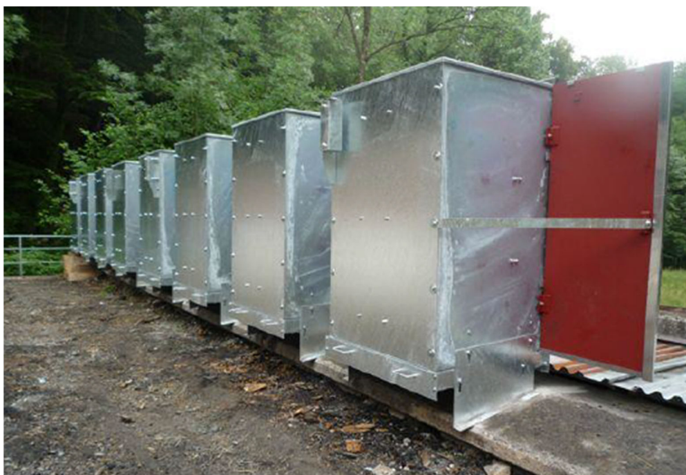
Figur 5 Baksiden av kulefangerkassetter med innvendige stålplater. Leu & Helfenstein AG
