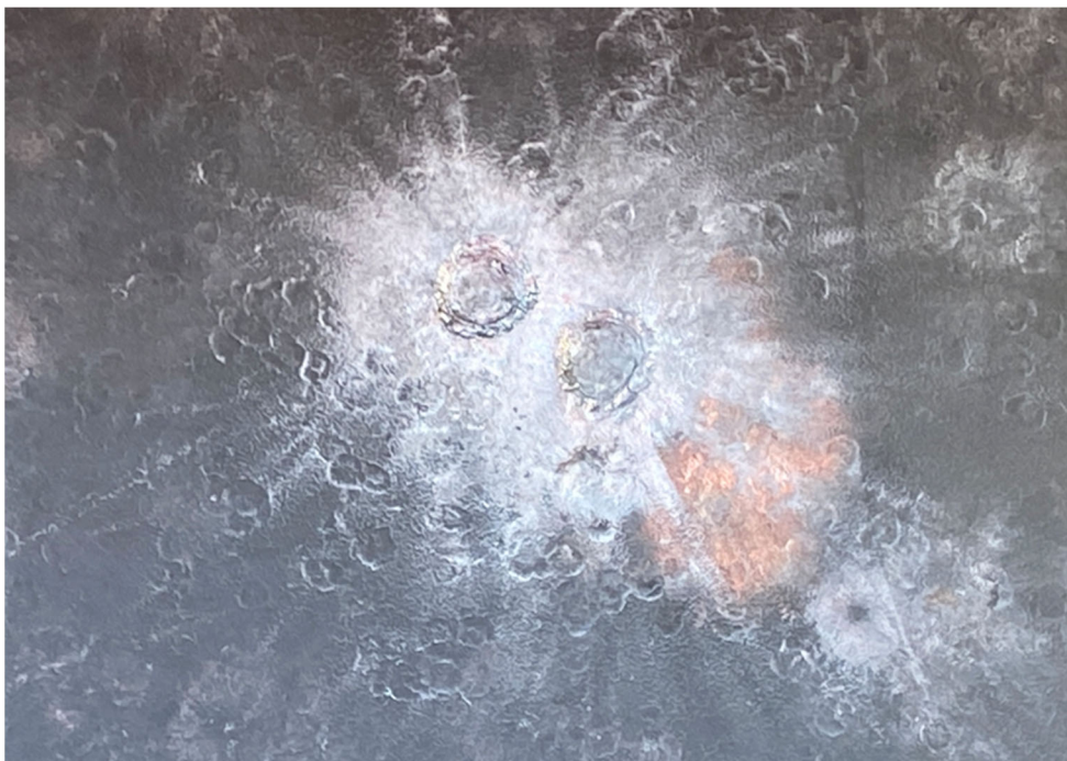
Figur 33 Bilde av treffplaten i prototype-kulefanget
