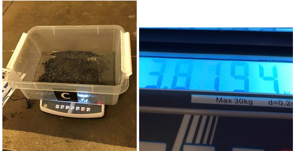
Figur 18 Veing av oppsamlede rester av prosjektilene fra stål 2 (COWI).
