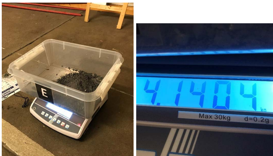
Figur 13 Veiing av oppsamlede rester av prosjektilene fra stål 2 (COWI).
