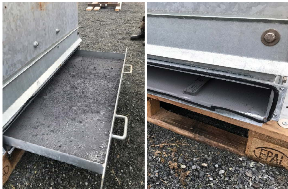
Figur 11 Bildet til venstre viser skuffen i stål 2 og til høyre vises åpningen hvor skuffen ble dratt ut fra, hvor en tydelig kan se metallstøvet (COWI).
