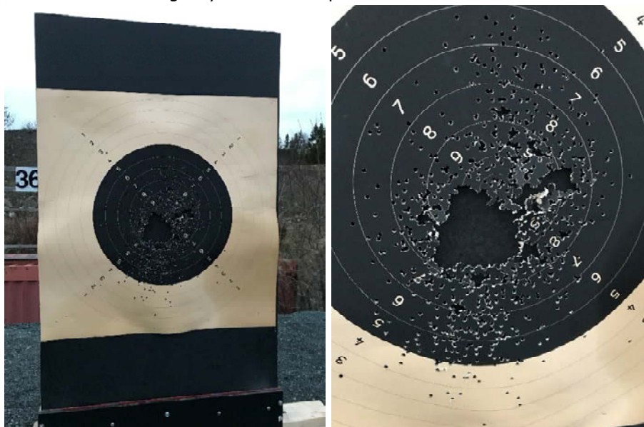
Figur 17 Resultatet for stål 2 etter runde 2. Det var synlige små hull/merker i PE plata (COWI).
