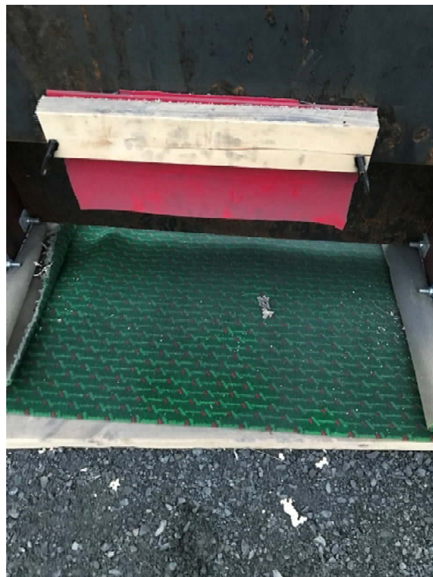
Figur 14 Resultatet for stål 1 etter runde 2. Ikke synlige hull i regupol platene (COWI).
