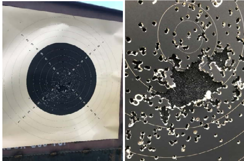
Figur 6 Resultatet for stål 1 etter runde 1. Ikke synlige hull i regupol platene (COWI)
