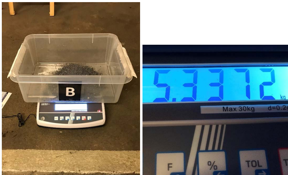
Figur 16 Veiing av oppsamlede rester av prosjektilene fra stål 1 (COWI).
