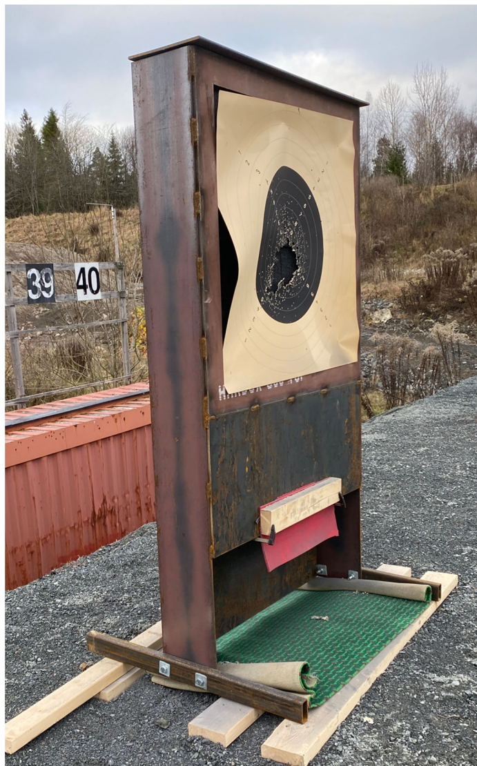
Figur 11 Bilde av selvutviklet prototype av en stålkulefang. Pappskiven er brukt til å sikte på under testskytingen.
