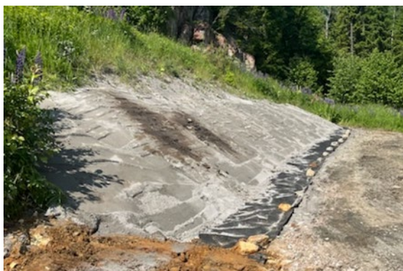
Figur 43 Forsøk med Dustex støvbinding for skive 1 og 2.
