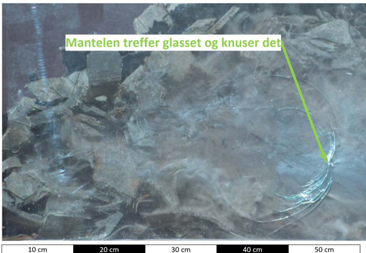
Figur 28 Mantelen har endret retning noe og treffer glasset som knuser. Mye synlig blystøv.
