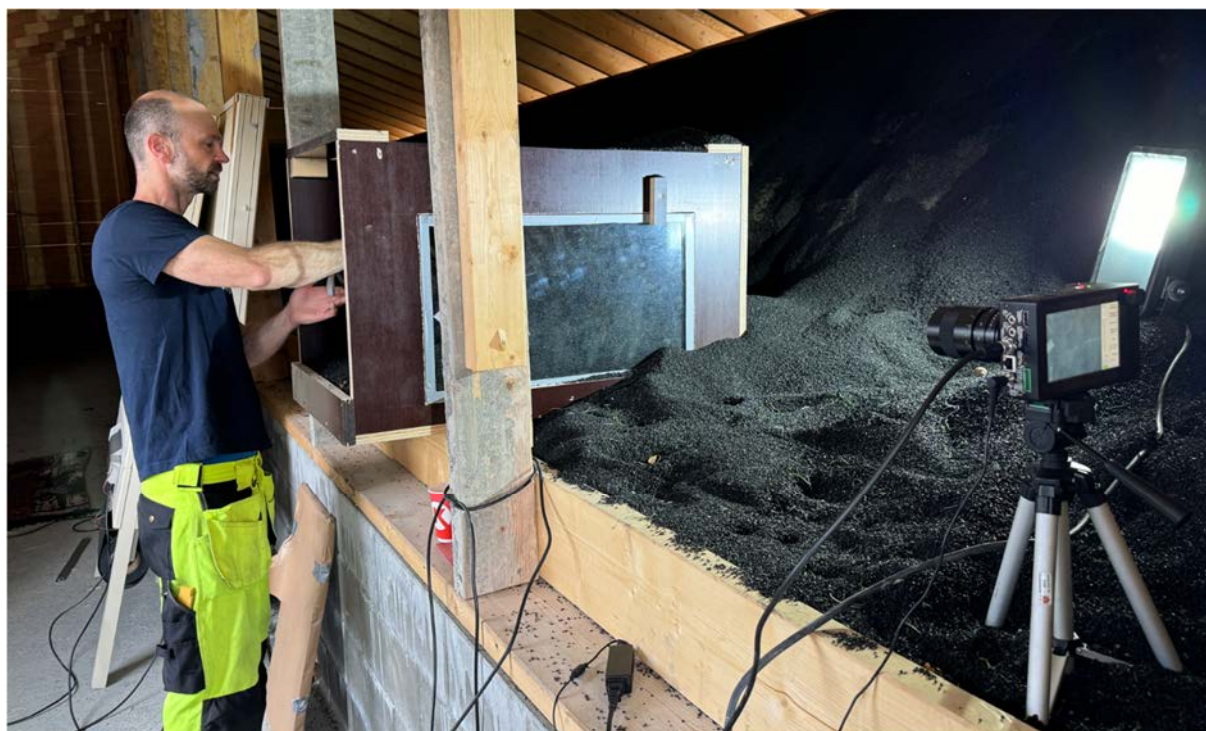
Figur 21 Testboks med glass i siden, høyhastighetskamera og Vegard Ulland som måler forurensning med XRF-apparat
