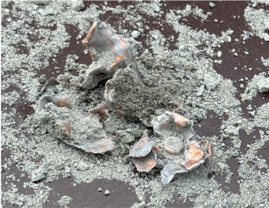
Figur 33 Kulerester fra grusen. Blyet er forstøvet og helt separert fra mantelen
