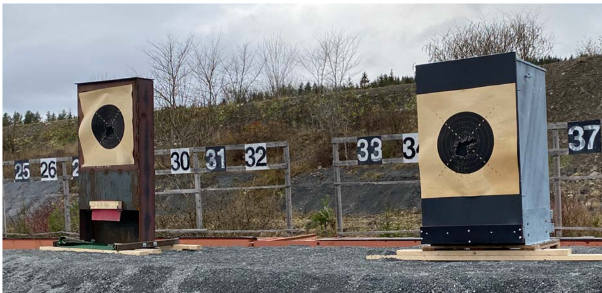
Figur 1 Egenutviklet prototype av stålkulefanger til venstre. Kulefanger fra Leu + Helfenstein til høyre.
