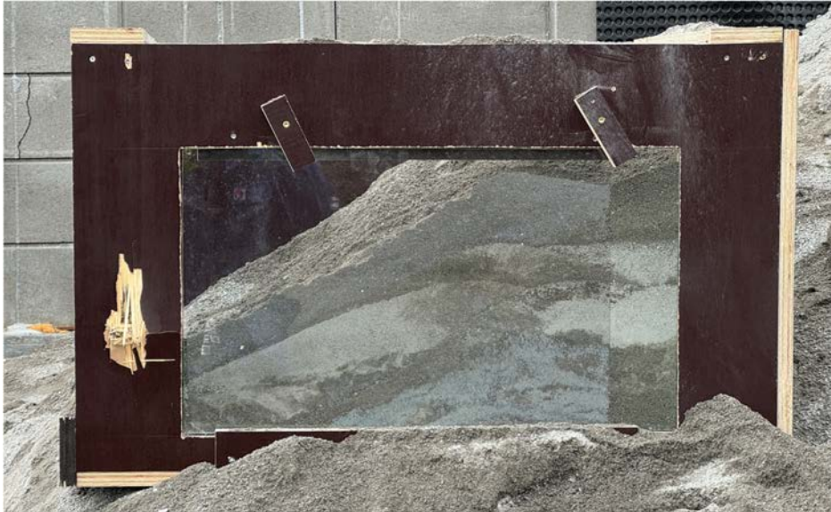
Figur 31 Test-kassen fylt med maskingrus av knust betong
