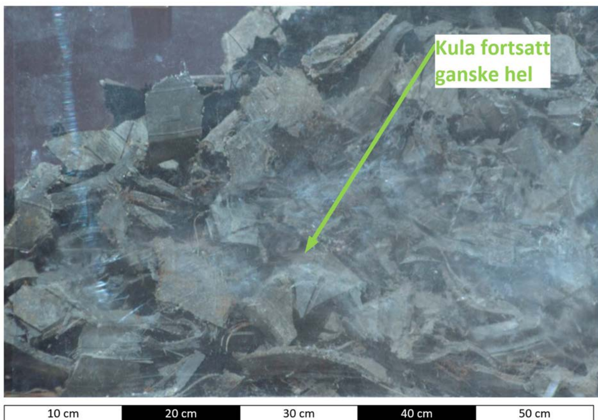
Figur 26 Kula fortsatt ganske hel og sees også her som en hvit stripe
