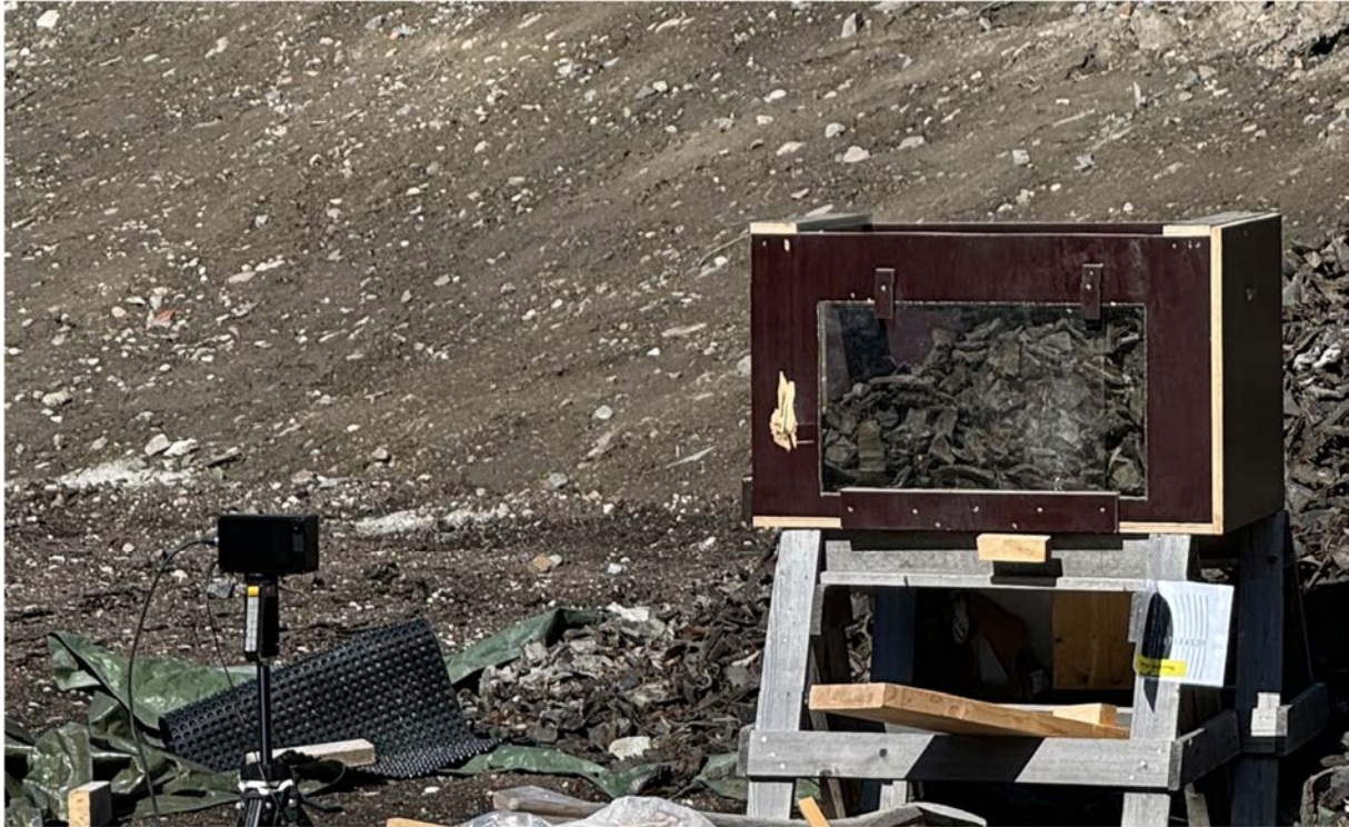
Figur 24 Testkasse med dekk-klipp klar til filming med høyhastighetskamera
