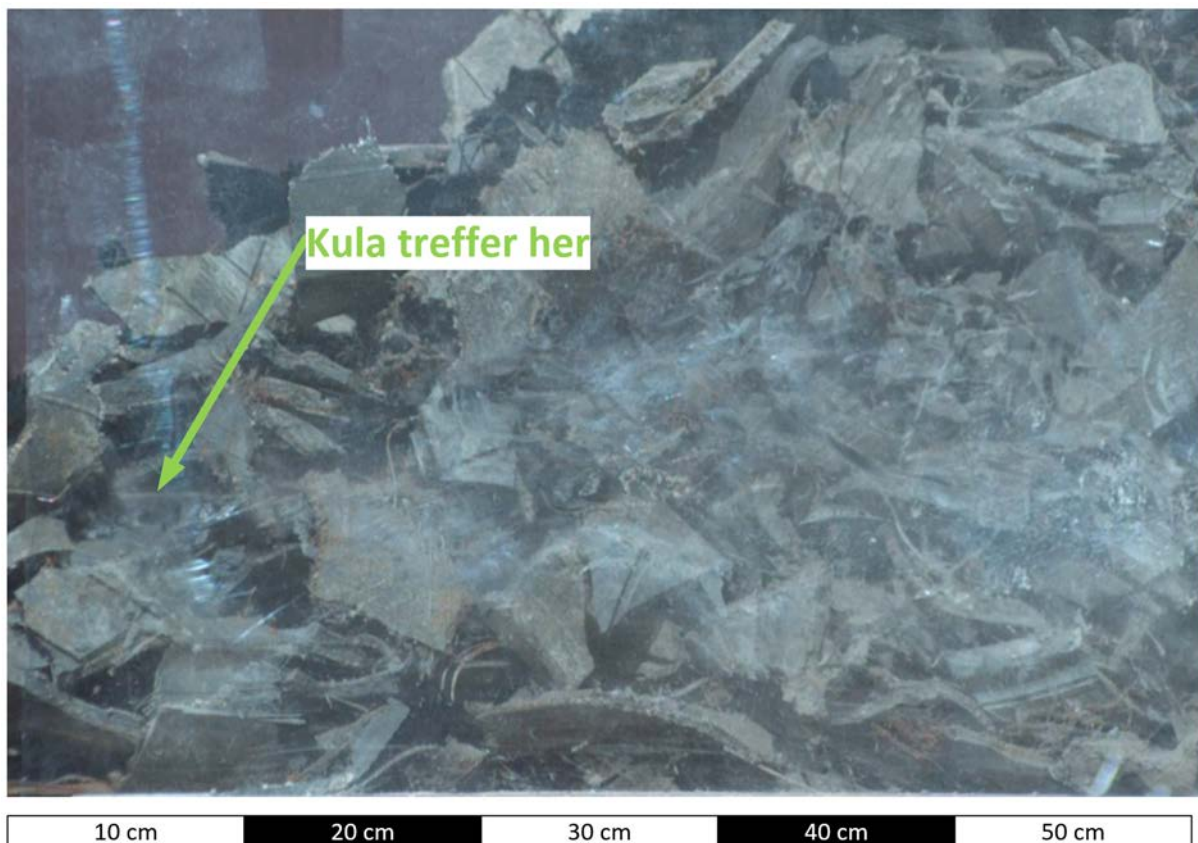
Figur 25 Kula på vei inn i dekk-klippet, og sees som en hvit stripe
