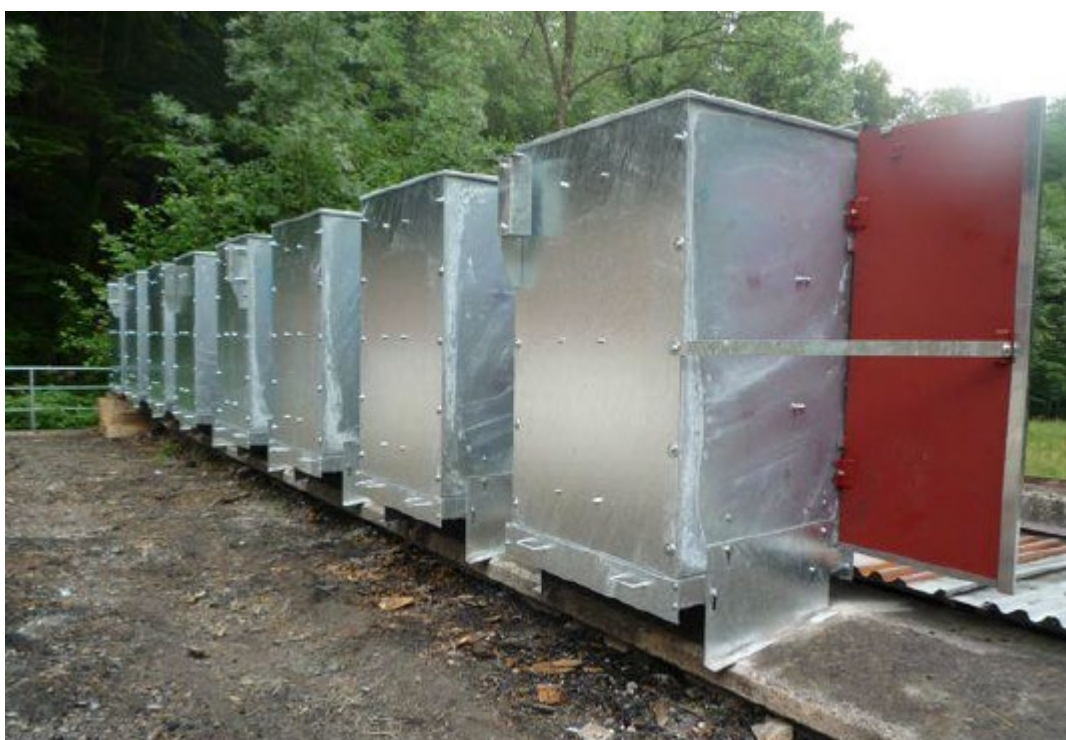
Figur 23 Baksiden av kulefangerkassetter med innvendige stålplater. Leu + Helfenstein AG (Sveits)
