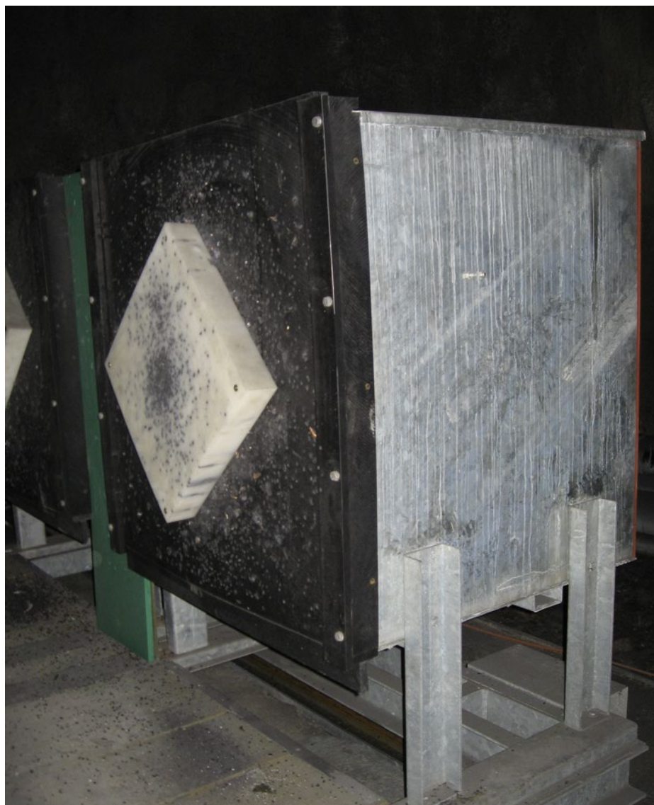
Figur 16 Stålkasse med gummigranulat og frontplate av HDPE. Brünig Indoor i Sveits
