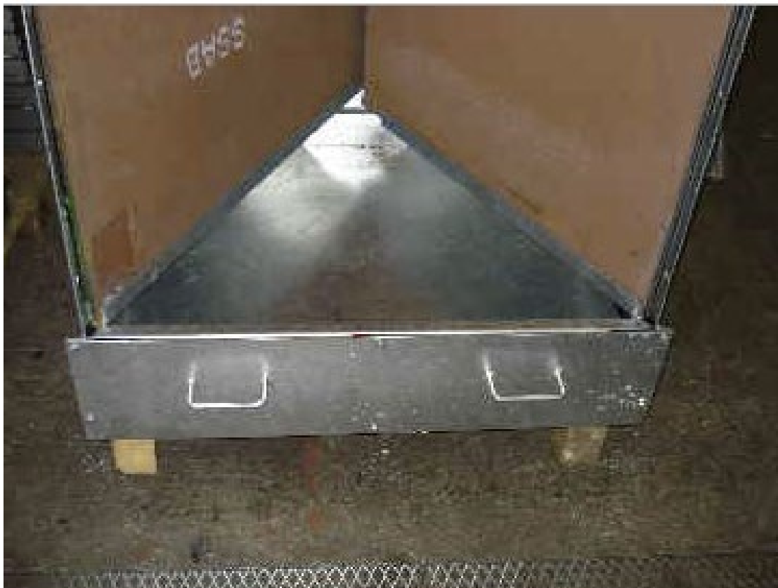
Figur 24 Innsiden av kulefangerkassett med stålplater. Leu + Helfenstein AG (Sveits)
